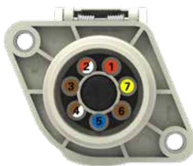
Steckbild der 7-poligen Steckdose nach ISO 25981 (Rückansicht) Contact allocation of the 7-pin socket according to ISO 25981 with color coding (rear view)
