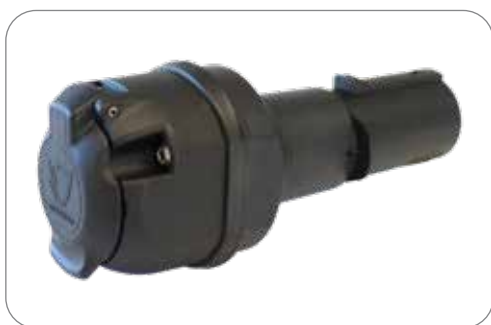
Adapter / Spannungsreduzierer 24V > 12V - Verbindet fahrzeugseitige 7P/24V Steckdose (ISO 1185) mit anhängerseitigem 13P/12V Stecker (ISO 11446) Adapter / Voltage Reducer 24V > 12V - Connects 7P/24V socket (ISO 1185) on vehicle side with 13P/12V plug (ISO 11446) on trailer side
