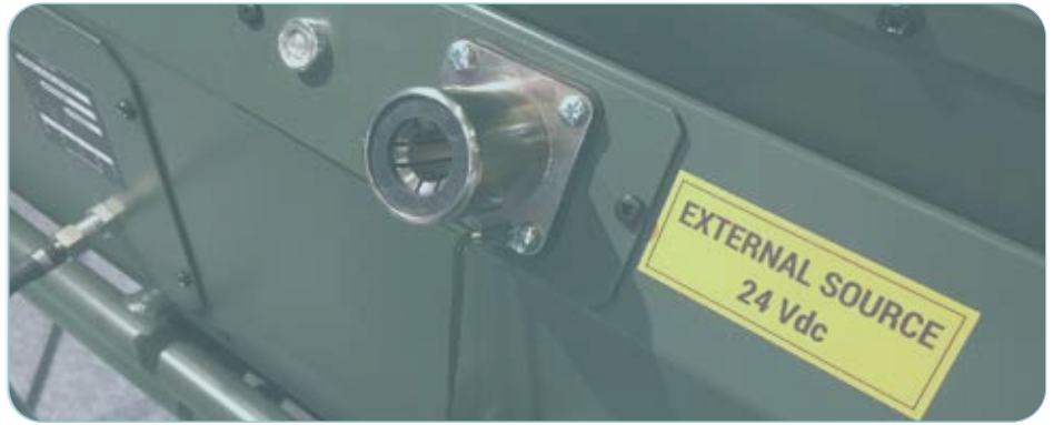
Anwendung eines Anhängersteckverbinders nach STANAG 4074 Application of trailer connectors according to STANAG 4074
