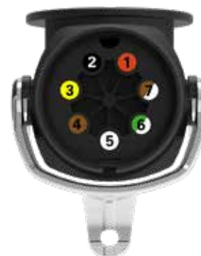
Steckbild des 7-poligen Steckers nach ISO 7638 Contact allocation of the 7-pin plug according to ISO 7638 with color coding
