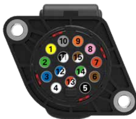
Steckbild der 15-poligen Steckdose nach ISO 12098 (Rückansicht) Contact allocation of the 15-pin socket according to ISO 12098 with color coding (rear view)
