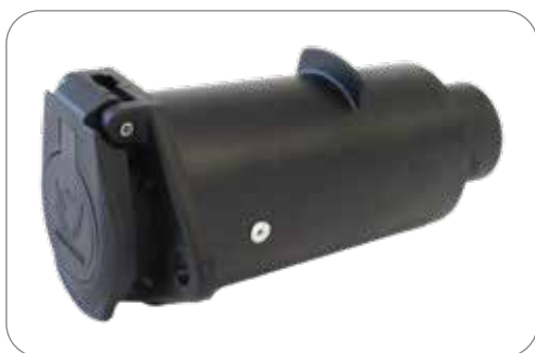
Adapter / Spannungsverdoppler 12V > 24V - Verbindet fahrzeugseitige 7P/12V Steckdose (ISO 1724) mit anhängerseitigem 7P/24V Stecker (ISO 1185) Adapter / Voltage Doubler 12V > 24V - Connects 7P/12V socket (ISO 1724) on vehicle side with 7P/24V plug (ISO 1185) on trailer side
