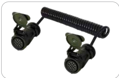
12P/24V Elektrowendel (VG 96927-22) mit 2x 12P/24V Stecker mit Kontakthülsen (nach VG 96923 B2-12S) 12P/24V Coil (VG 96927-22) with 2x 12P/24V plug with contact sockets (accord. to VG 96923 B2-12S)
