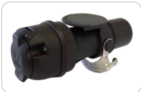
Adapter / Spannungsreduzierer 24V > 12V - Verbindet fahrzeugseitige 15P/24V Steckdose (ISO 12098) mit anhängerseitigem 13P/12V Stecker (ISO 11446) Adapter / Voltage Reducer 24V > 12V - Connects 15P/24V socket (ISO 12098) on vehicle side with 13P/12V plug (ISO 11446) on trailer side
