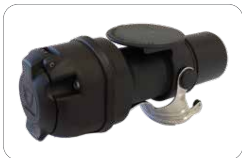
Adapter / Spannungsreduzierer 24V > 12V - Verbindet fahrzeugseitige 15P/24V Steckdose (ISO 12098) mit anhängerseitigem 13P/12V Stecker (ISO 11446)
