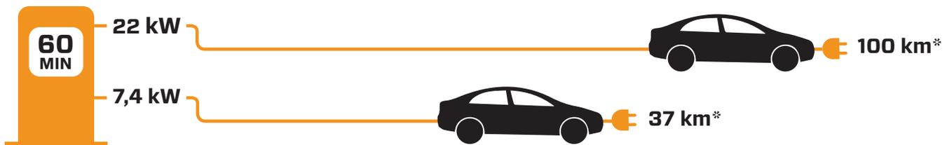
\* Ladekabel 22 kW: Abhängig vom Model des Elektrofahrzeugs: Ladezeit eine Stunde – Reichweite bis zu 100 km
